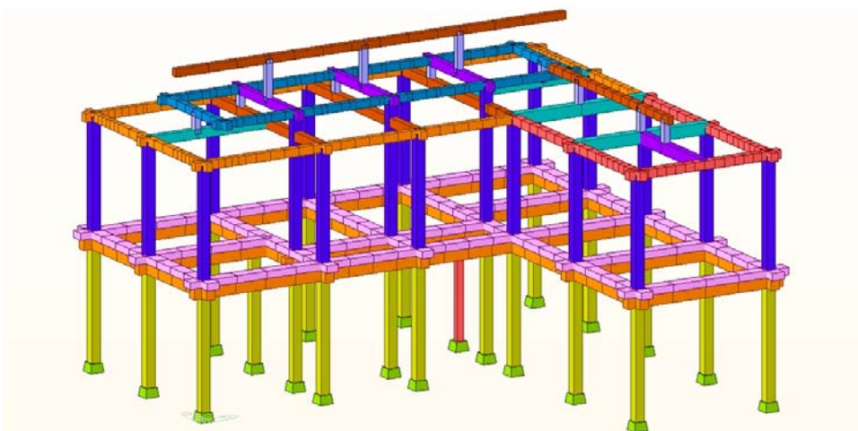
그림 12. 시범한옥의 구조모델링 과정 (동자기둥, 종도리)
